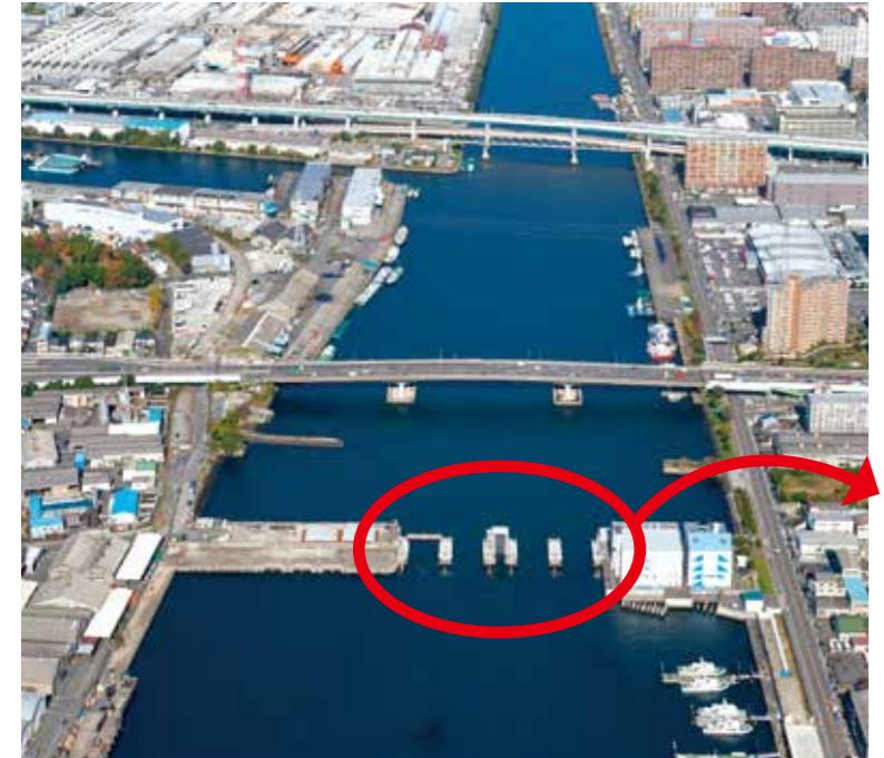
昭和34年9月、この地域に甚大な被害をもたらした伊勢湾台風の教訓から、市街地への高潮の浸水を防ぐため、堀川河口に防潮水門が設置されています。しかし、現在のマイターゲート式水門では津波に対応する能力が低く、万が一津波が発生した際には、水門が変形し崩壊する恐れがあることがわかっています。服部しんのすけ市議は、想定される南海トラフ地震が起れば、津波が押し寄せる可能性があり危険になると昨年の11月定例会において、新水門の整備に向けて住宅都市局長に対し、強く要望しました。
